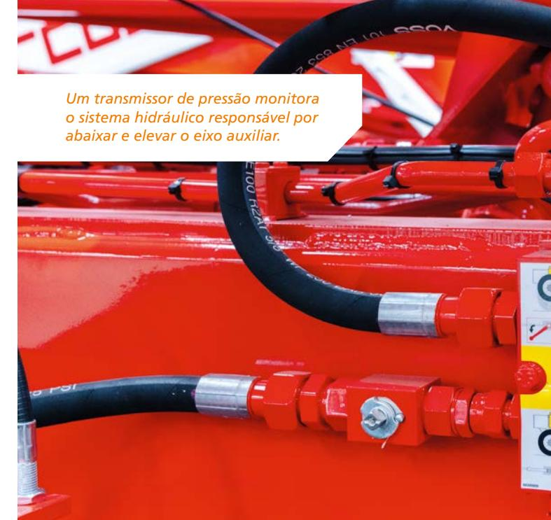
*Um transmissor de pressão monitora o sistema hidráulico responsável por abaixar e elevar o eixo auxiliar.*
