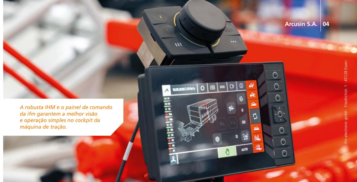
*A robusta IHM e o painel de comando da ifm garantem a melhor visão e operação simples no cockpit da máquina de tração.*
