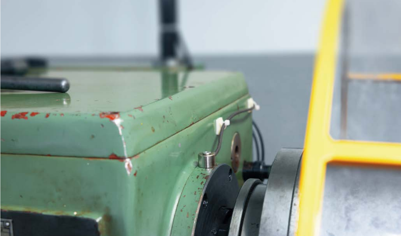
L'« oreille » de la machine : le capteur de vibrations VSA005 détecte les spectres vibratoires de tous les roulements du système d'entraînement de la machine.
