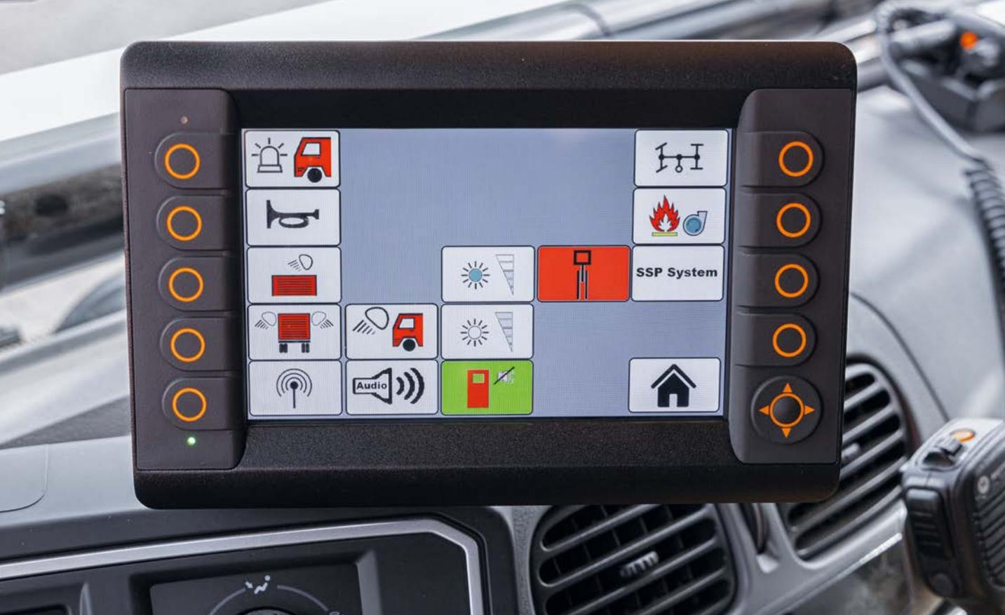
L'écran tactile programmable CR1082 du cockpit permet au conducteur de commander toutes les fonctions spéciales et les agrégats.
