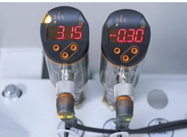
Drucksensoren überwachen den Druck im Kühlkreislauf.
