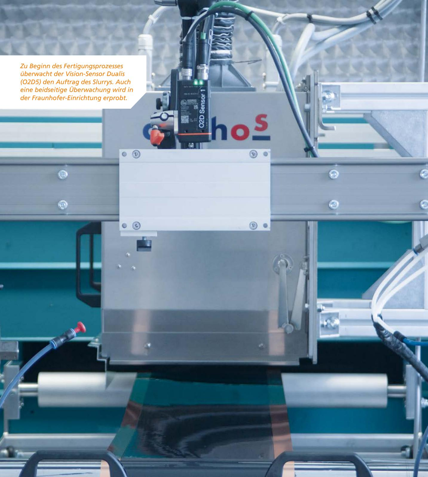
Zu Beginn des Fertigungsprozesses überwacht der Vision-Sensor Dualis (O2D5) den Auftrag des Slurrys. Auch eine beidseitige Überwachung wird in der Fraunhofer-Einrichtung erprobt.
