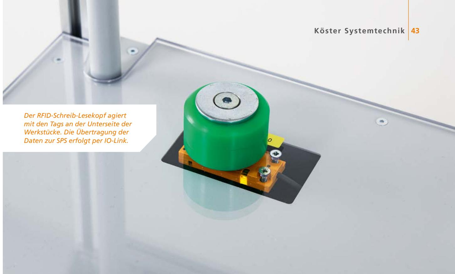
*Der RFID-Schreib-Lesekopf agiert mit den Tags an der Unterseite der Werkstücke. Die Übertragung der Daten zur SPS erfolgt per IO-Link.*
