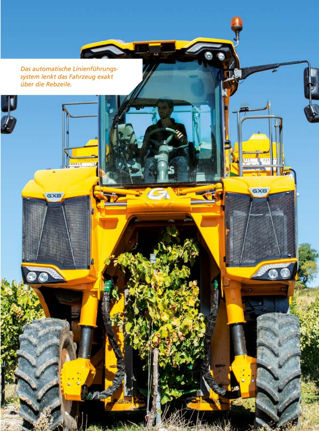
Das automatische Linienführungssystem lenkt das Fahrzeug exakt über die Rebzeile.
