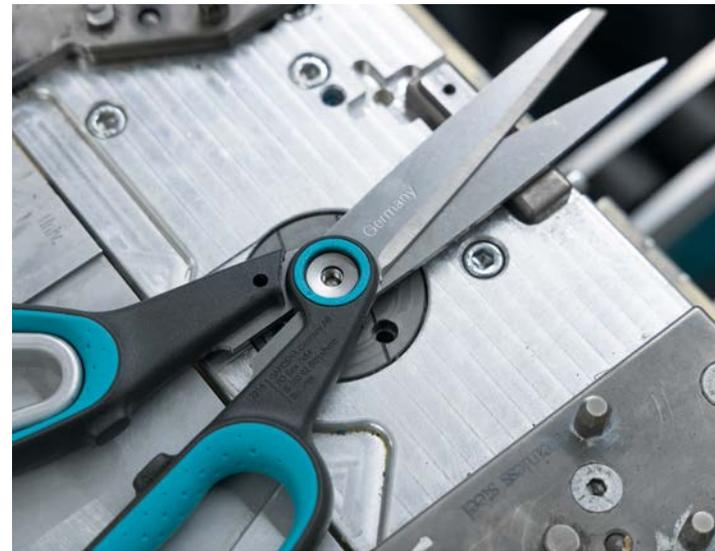
Der Vision Sensor prüft, ob die Tellerfeder am Gelenk eingelegt wurde und ob sie richtig (links) oder falsch herum (rechts) liegt. Ausschuss durch Montagefehler wird somit ausgeschlossen.
