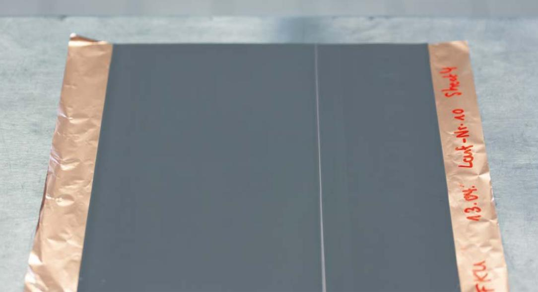
Ausgelassene Bereiche im Slurry-Auftrag führen zum Ausschuss und müssen zwingend identifiziert werden. Der Vision-Sensor Dualis von ifm signalisiert diesen Fehler und hilft damit, die Ausschussmenge zu minimieren.
