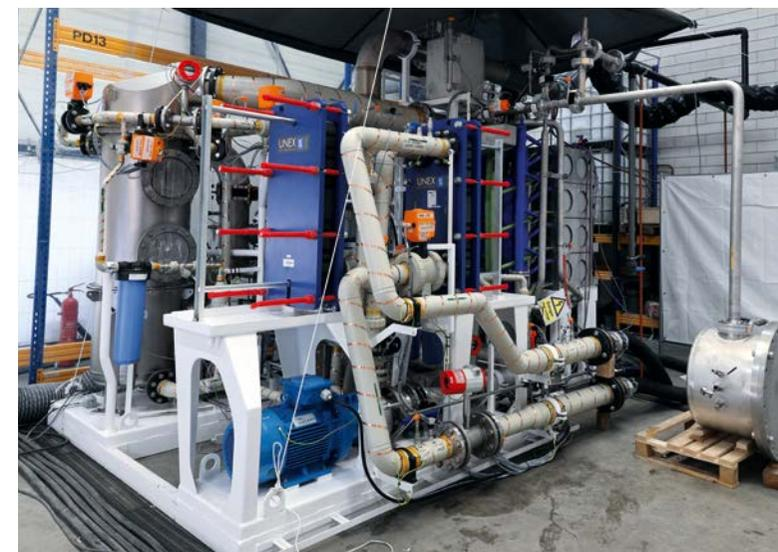
Der von Koedood und Kooiman entwickelte Wasserstoffantrieb K2, im Testbetrieb kurz vor dem Einbau.
