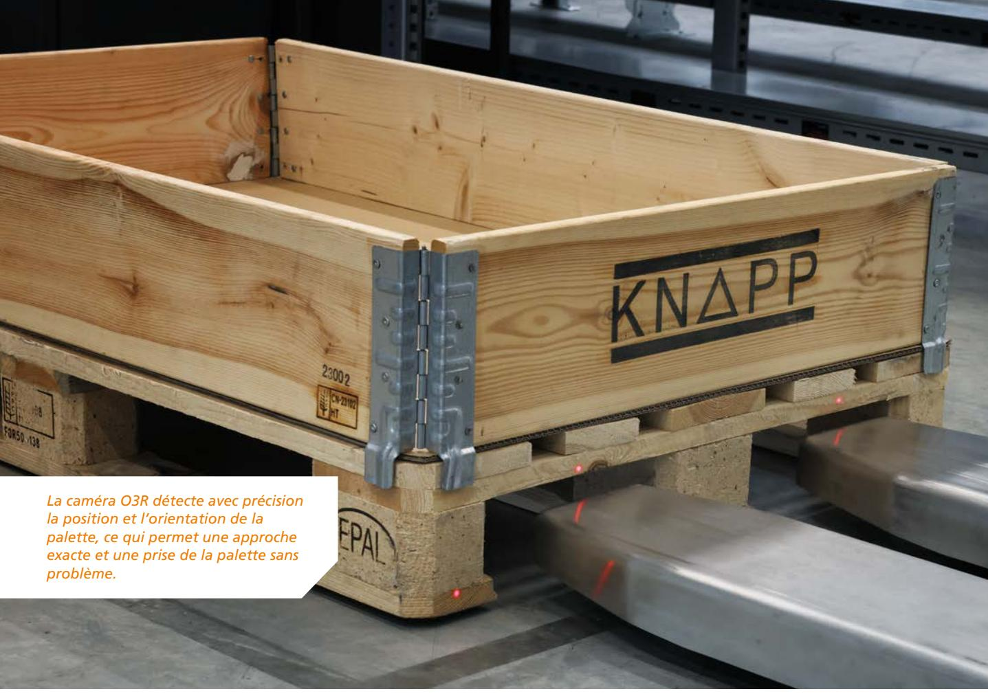
**La caméra O3R détecte avec précision la position et l'orientation de la palette, ce qui permet une approche exacte et une prise de la palette sans problème.**
