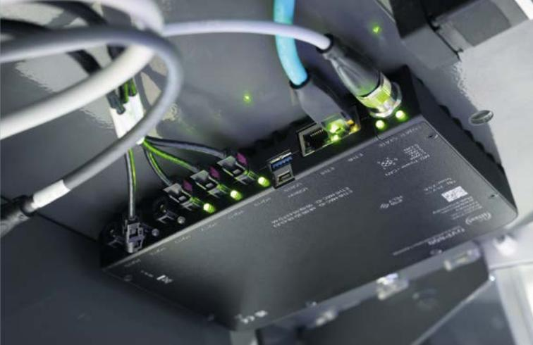
L'élément central du système O3R est l'unité de traitement vidéo. Elle offre des possibilités de connexion pour jusqu'à 6 caméras.
