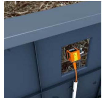
Mesure de niveau dans la livraison du sucre de canne.
