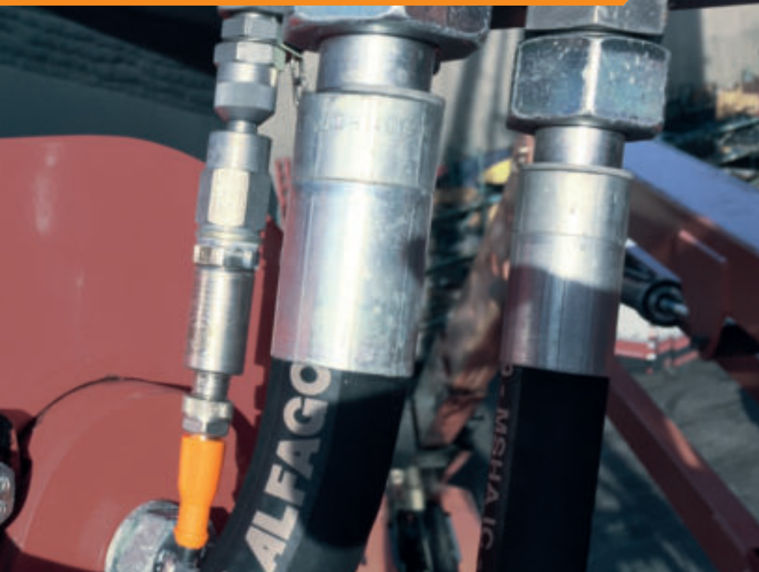
PU/PT型 圧力トランスミッター モバイルアプリケーション用。
