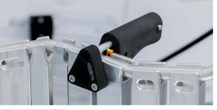
Uno dei vari sensori ottici rileva se il tubo è inserito nel calibro. Il blocco viene rilasciato solo quando tutte le fasi del controllo qualità sono state completate con successo.
