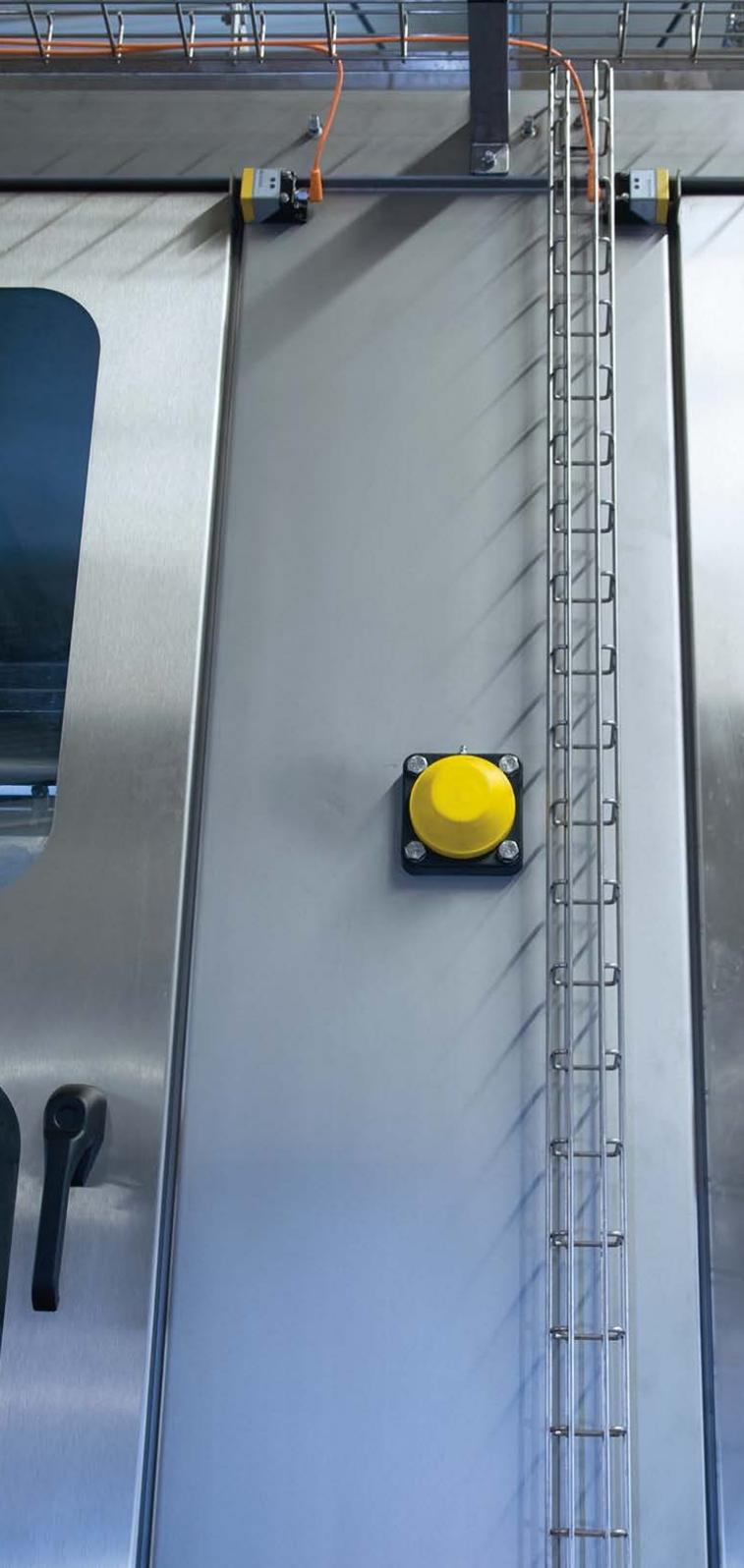
系統的門透過自動防故障電感式感應器監控。
