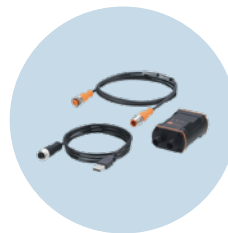
IO-Link 인터페이스 PC에서 IO-Link 디바이스의 파라미터 세팅용
