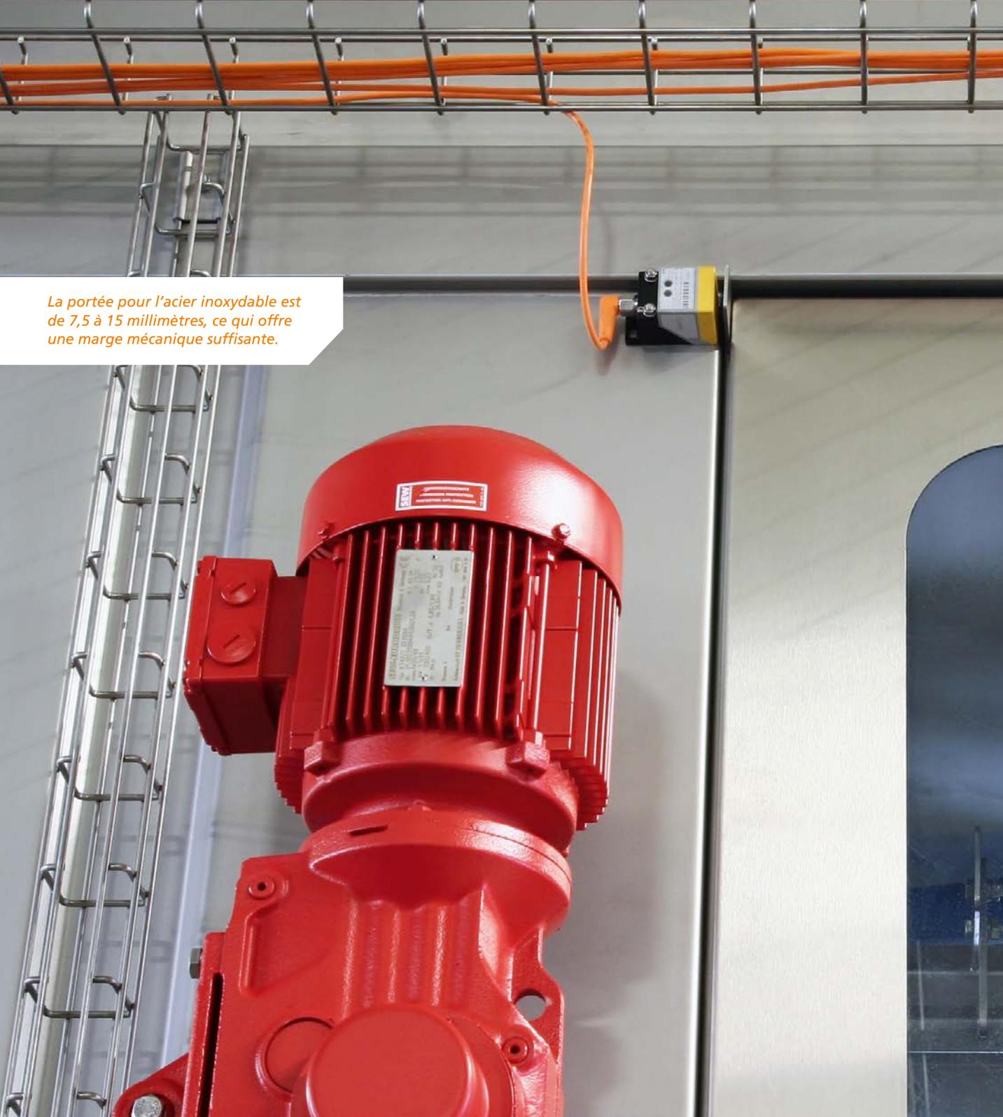
La portée pour l'acier inoxydable est de 7,5 à 15 millimètres, ce qui offre une marge mécanique suffisante.
