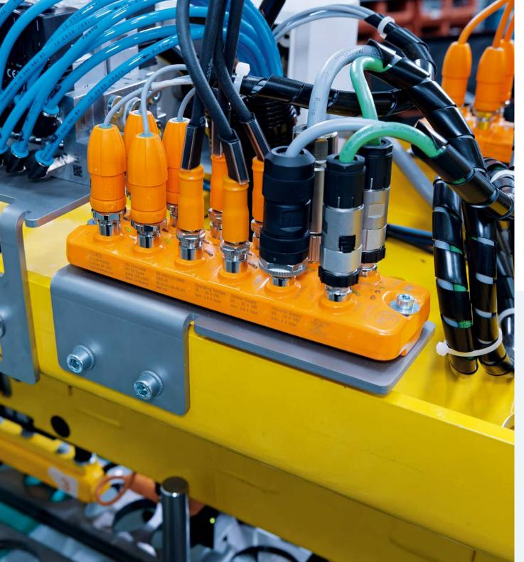
I master IO-Link PerformanceLine, qui con interfaccia Profinet, facilitano e accelerano il collegamento dei sensori e forniscono un'alimentazione sufficiente agli attuatori.
