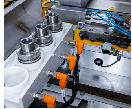
I sensori induttivi rilevano la presenza delle teste di fresatura (a sinistra), una barriera luminosa assicura l'esatto posizionamento dei pezzi prima della saldatura mentre un encoder assoluto multigiro viene utilizzato per la misurazione precisa della lunghezza (in basso): Kettec si affida ai sensori di ifm.
