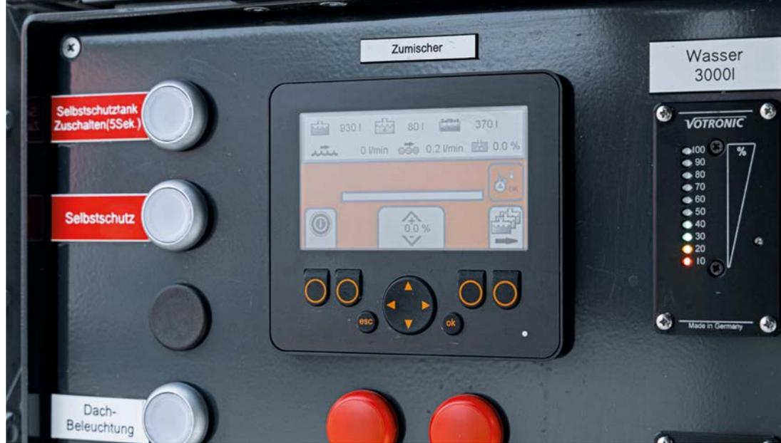
특수 신호 시스템 (점멸되는 청색 표시등 및 사이렌) 또는 비상 상황 보장을 위한 기타 신호등 및 조명 등의 추가 장비는 모니터를 통해 시각화 및 작동되며 중앙 PLC에 의해 컨트롤됩니다. 도어 또는 롤러 셔터는 유도형 센서를 통해 모니터링되는데, 이는 차량이 닫힌 상태에서만 주행이 허용된다는 것을 의미합니다.
