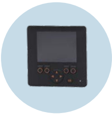
그래픽 디스플레이 특수이동차량 컨트롤용으로 프로그래밍 가능한 HMI
