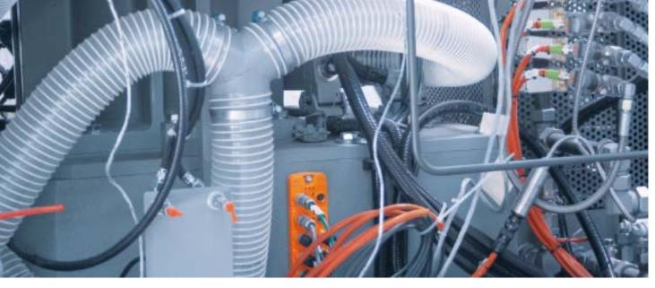
Die Sensordaten der Recycling-Anlage werden dezentral per IO-Link-Master gesammelt und gebündelt an die Steuerung weitergeleitet.
