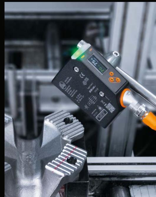
Qualitätskontrolle im Maschinenbau: Der ifm Profiler kontrolliert millimetergenau die Profilhöhe eines Bauteils.
