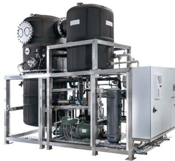
Son directeur, **Sascha Holthusen**, explique : « C'est pour le traitement de ce type d'eaux usées industrielles que nous avons développé notre évaporateur sous vide. L'émulsion de lubrifiant réfrigérant usagé transite par l'évaporateur, et il en ressort d'un côté une petite quantité de concentré, de l'autre un distillat propre, c'est-à-dire de l'eau pure, qui peut être utilisée pour d'autres processus ou mise à l'égout sans nécessiter de frais importants pour l'élimination. »
