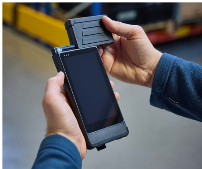
手持裝置上緣的各種天線模組可以輕鬆更換。
