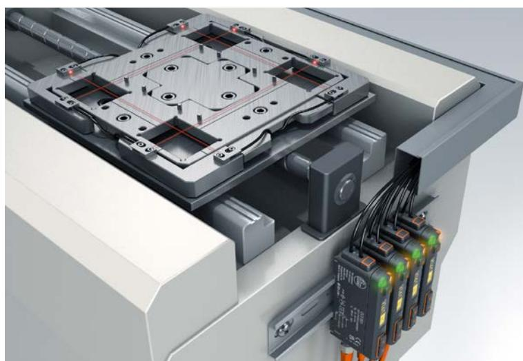
Les amplificateurs pour fibres optiques OCF peuvent être montés sur un rail DIN pour un gain de place optimal. De là, les fibres optiques mènent directement aux points de détection, où les objets ou les positions sont identifiés avec précision.
