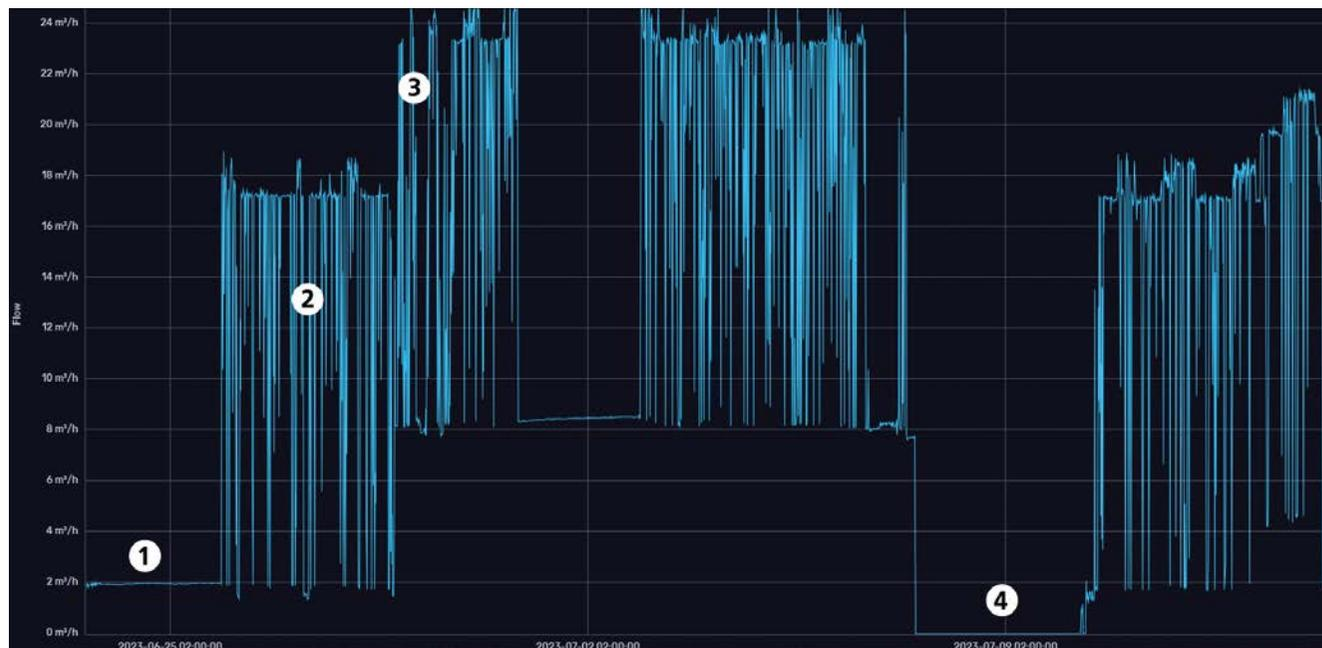
Informações valiosas sobre a rede de ar comprimido. Claramente reconhecível: o consumo básico (1) e o consumo de produção (2) aumentam significativamente após a ocorrência do vazamento (3). Depois que o vazamento é eliminado, o consumo básico cai para quase zero (4).
