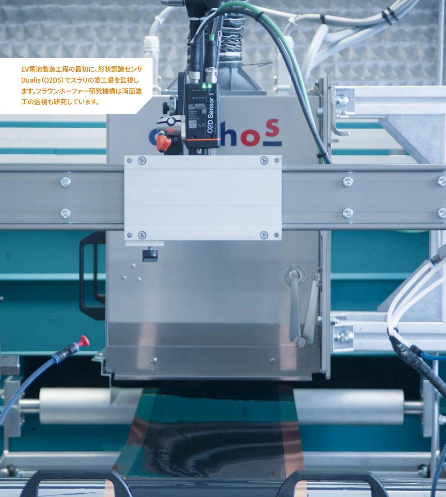
EV電池製造工程の最初に、形状認識センサ Dualis (O2D5) でスラリの塗工量を監視します。フラウンホーファー研究機構は両面塗工の監視も研究しています。
