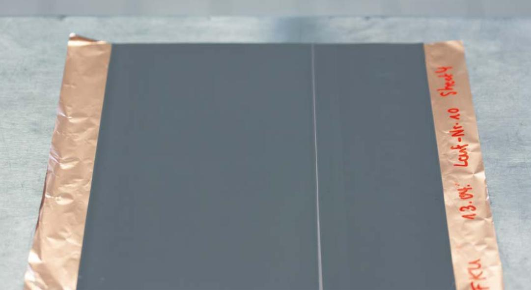
塗工に隙間がある電極箔を確実に見つけて廃棄します。ifmの形状認識センサ Dualisで、このような欠陥を検出して不良率を低減できます。
