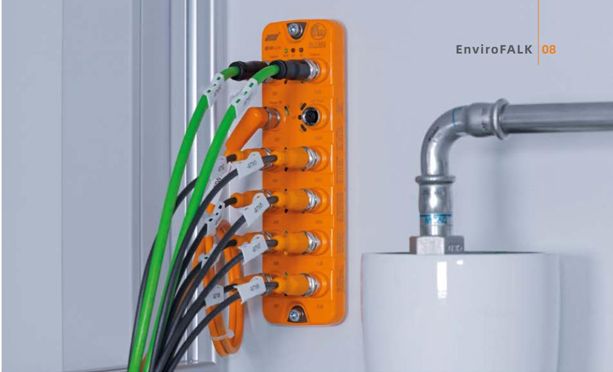
指定为L/min.或m<sup>3</sup>/h。并且，IO-Link还让我能传输同一传感器的多个测量值。例如电导率传感器，以及我们在储罐和泵上使用的压力传感器：我们通过测量压力来确定储罐中的液位，并同时读取该传感器提供的温度值，以了解储罐中的介质温度。这样，我们就无需安装额外的温度传感器，并在储罐中额外加装螺丝。SU型流量计也可通过同一数据线路传输多个测量值：除了流量和传感器状态外，还可通过IO-Link传输总流量和温度值。多亏了数据存储功能，当使用了错误的传感器或存在接线错误时，我们和最终客户可以立即发现。借助该功能以及主站和设备上预接线M12电缆的简单连接，我们不再需要资深的电工即可快速更换传感器。”
