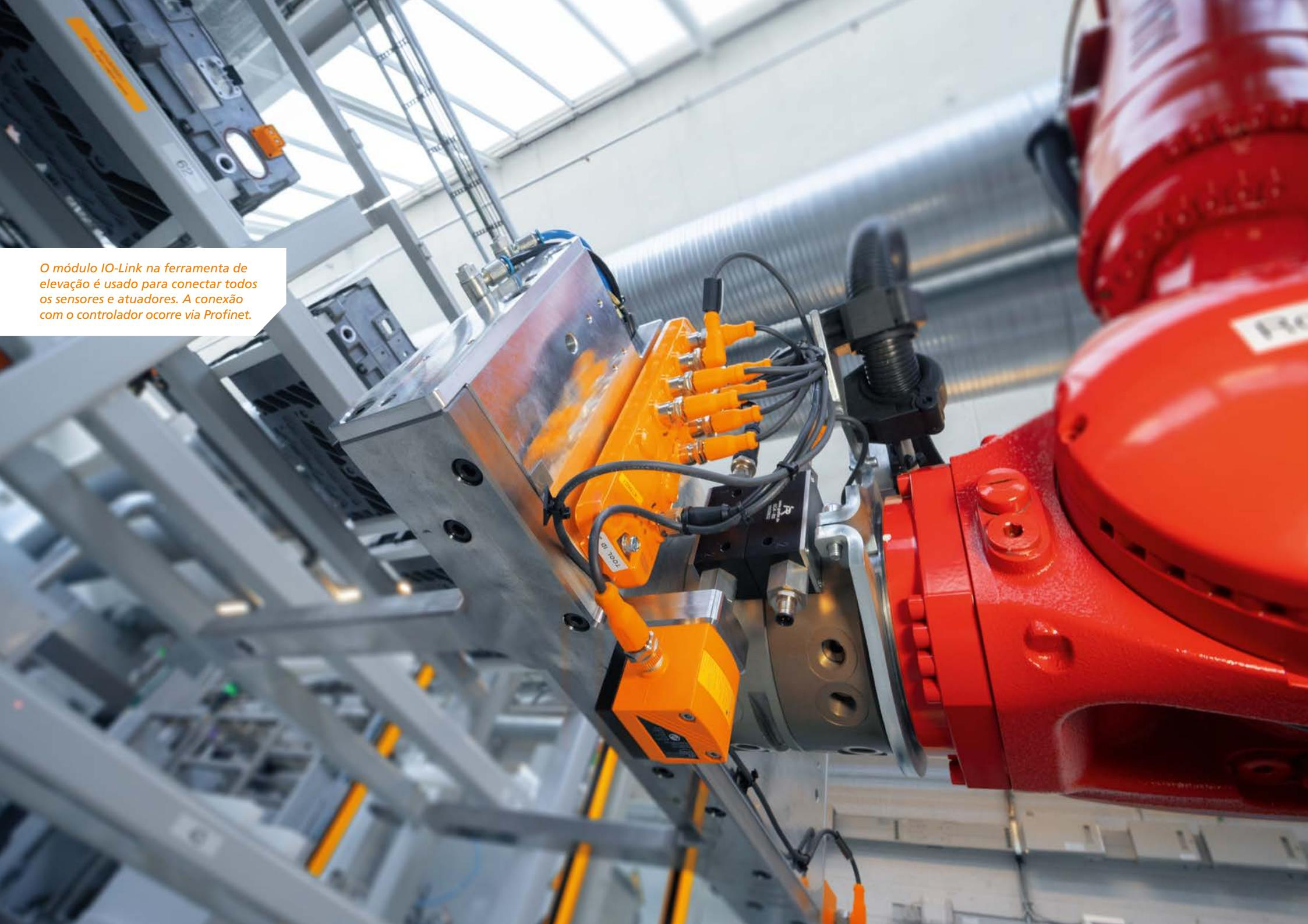
O módulo IO-Link na ferramenta de elevação é usado para conectar todos os sensores e atuadores. A conexão com o controlador ocorre via Profinet.
