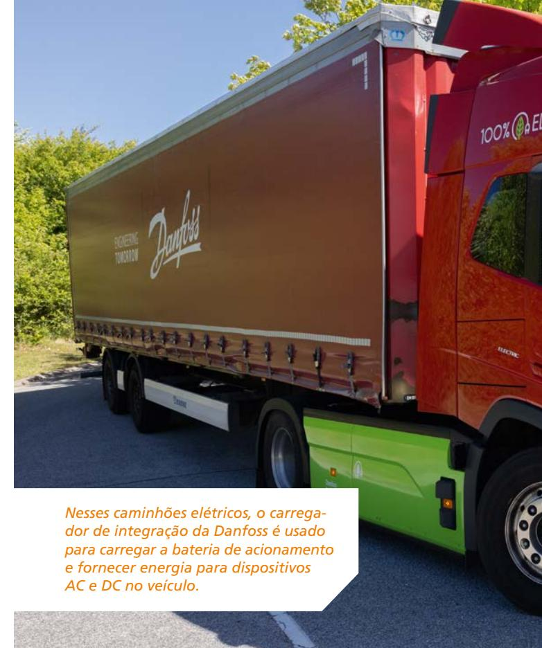
Nesses caminhões elétricos, o carregador de integração da Danfoss é usado para carregar a bateria de funcionamento e fornecer energia para dispositivos AC e DC no veículo.
