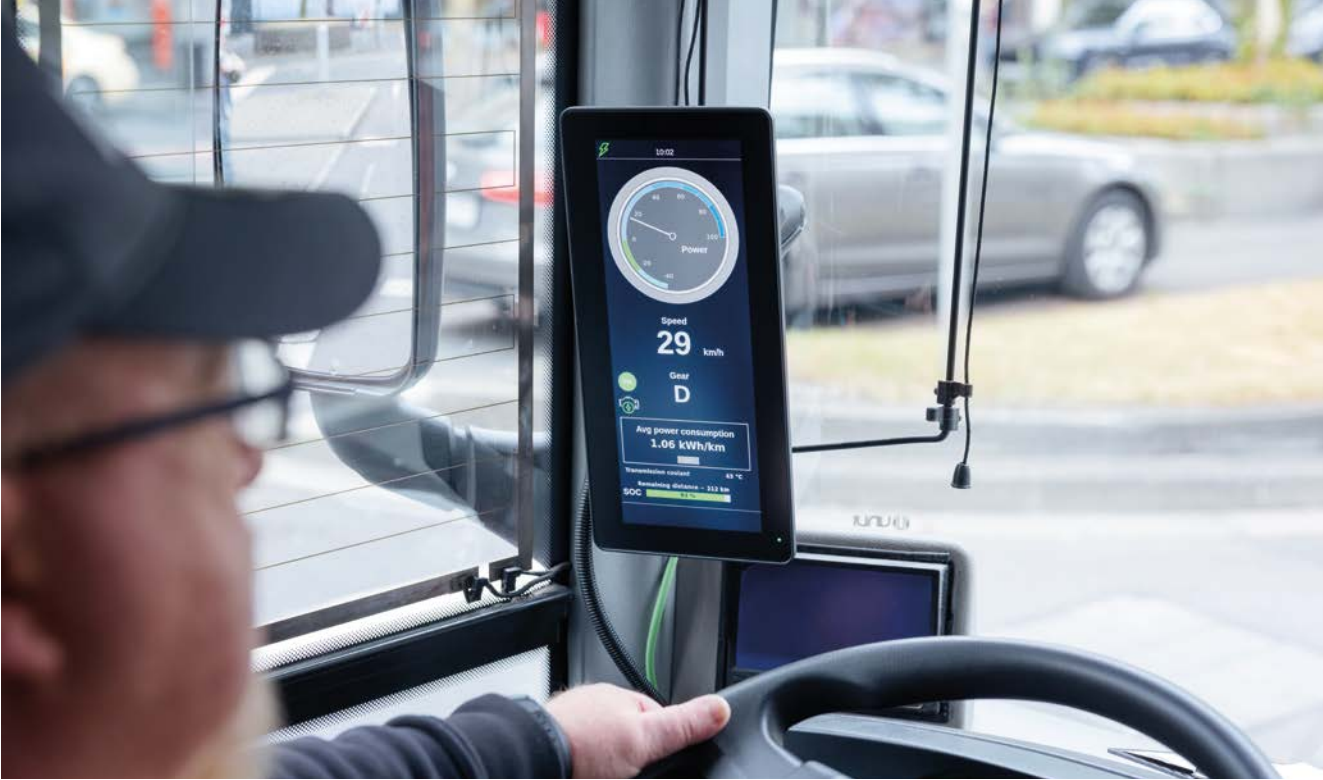
在駕駛艙內，堅固耐用的 CR1203 圖形顯示器可為駕駛員提供電力驅動系統的所有關鍵參數。
