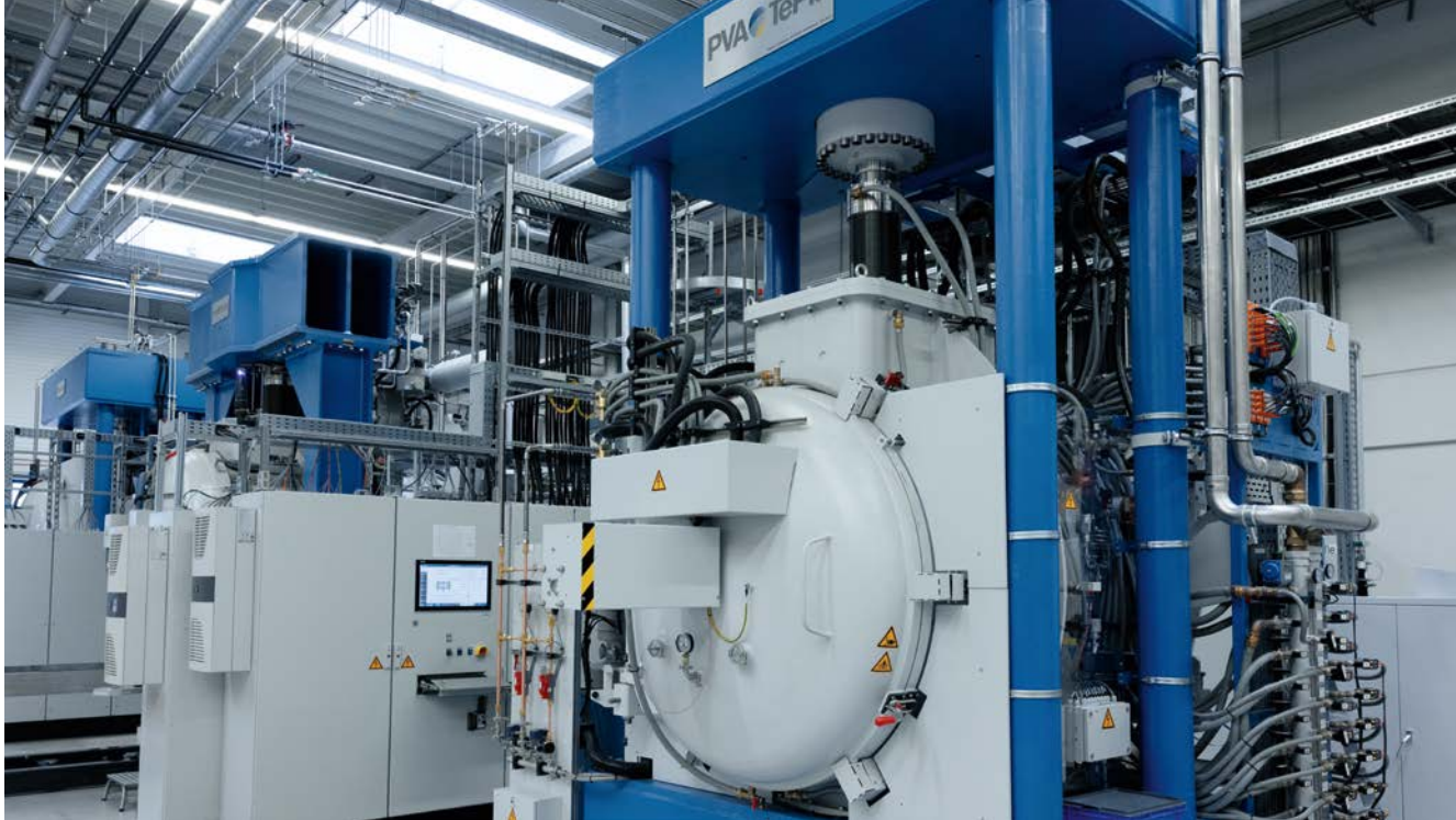
在機器中，各層材料在高壓下融合為單一結構。
