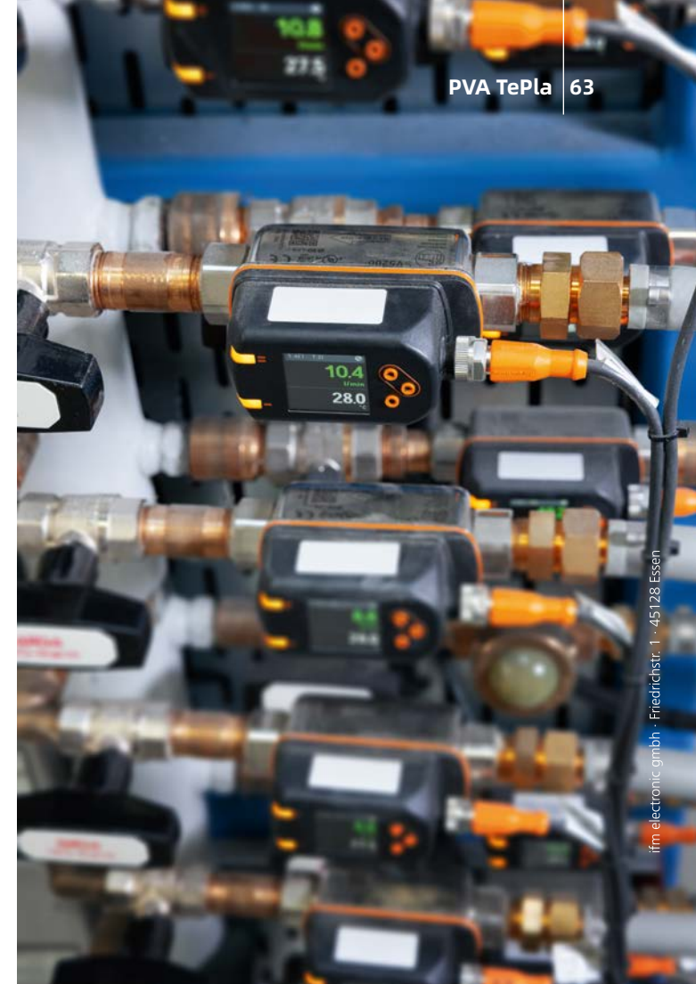
清晰易讀：擴散焊接系統上的流量感測器。
