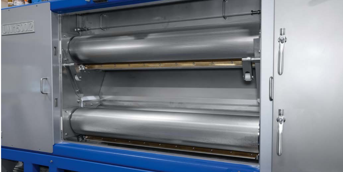
老式磨盤的時代已經過去： 兩段式磨豆機的不鏽鋼滾筒。
