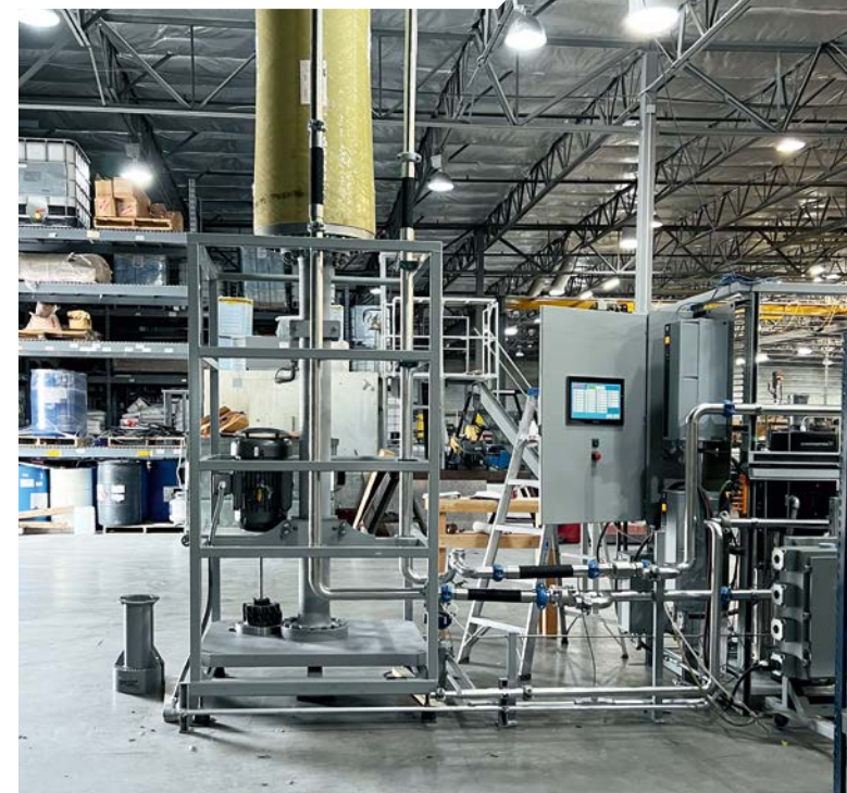
整體系統的核心：過濾系統與 20 馬力電動機，它讓薄膜產生振動作用。
