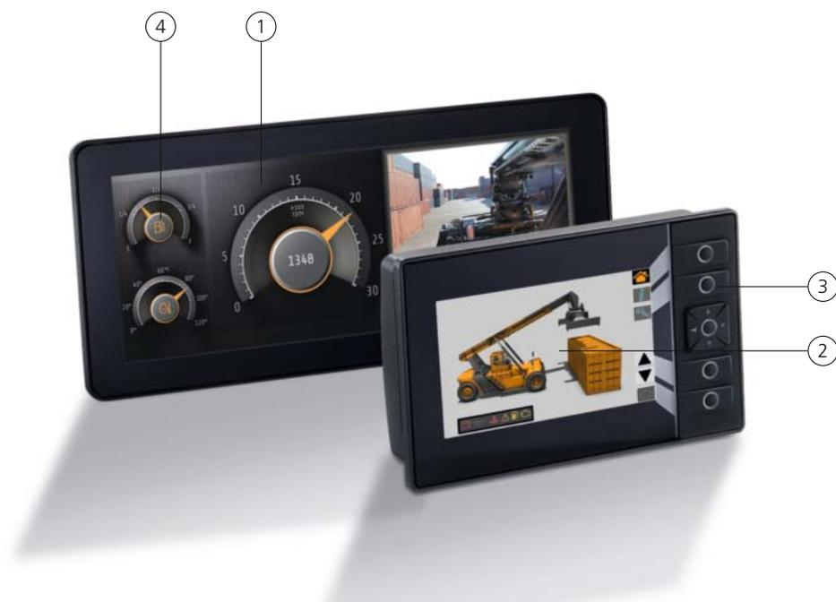
*Integrierte Schnittstellen für Ethernet, CAN, USB und Analogkameras.*
