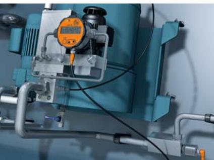
**Partikelüberwachung in Hydraulikölen.**
