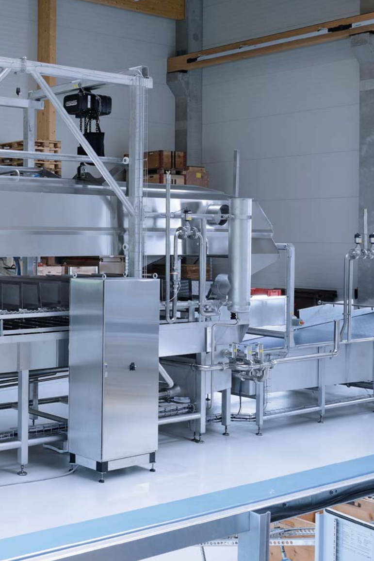
Impianto di cottura del tipo staedler CK1600, costruito dalla ditta staedler automation AG. Con questo impianto verranno cotti spätzle in un bagno di acqua.
