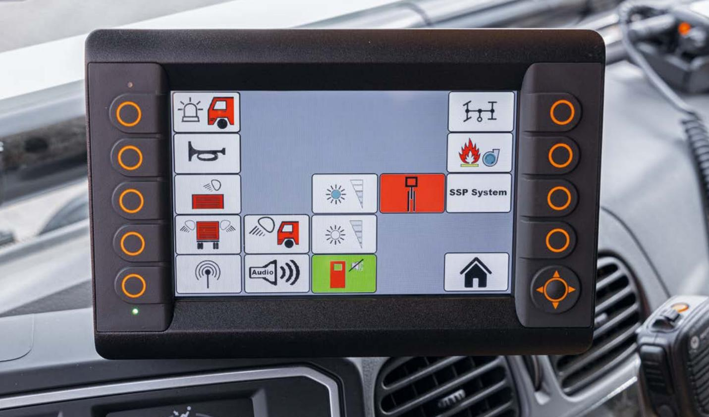
*Il conducente può controllare tutte le funzioni speciali e gli aggregati tramite il display grafico programmabile CR1082 nella cabina di guida.*
