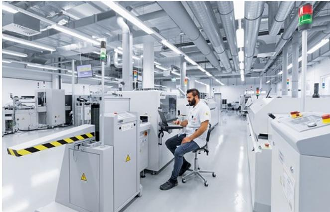
Außerhalb der Nasstechnik, aber für die Gesamtemissionen im EMAS-Bereich äußerst relevant, ist das Plasmaätzen mit  $\text{CF}_4$  (Tetrafluormethan). Das Bestücken und Löten wird auch hier mittels Reflow Lötverfahren, in eigens dafür gebauten Lötstationen, durchgeführt. Es wird ohne Stickstoffatmosphäre gelötet. Auch hier erfolgt nach der Bestückung und vor dem Versand an die technischen Standorte eine 100 %-Prüfung.
