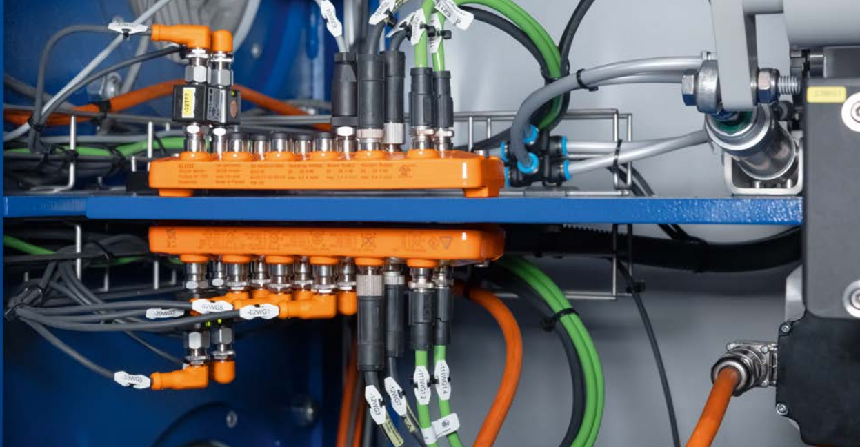
Die Signale sämtlicher Sensoren werden über IO-Link-Master gebündelt und per PROFINET an die Maschinensteuerung übertragen.
