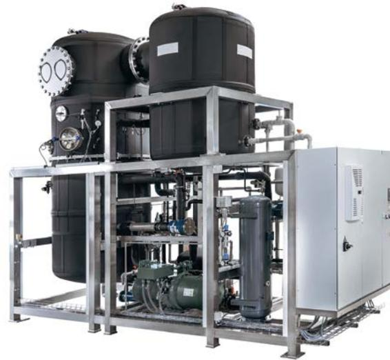
O diretor **Sascha Holthusen** explica: “Desenvolvemos nosso evaporador a vácuo para o tratamento desse tipo de água residual industrial. A emulsão do lubrificante de refrigeração usada é introduzida no sistema e, como resultado, obtém-se uma pequena quantidade de concentrado, bem como um destilado limpo, ou seja, água pura, que pode ser usada em outros processos ou eliminada no esgoto sem custos elevados.”
