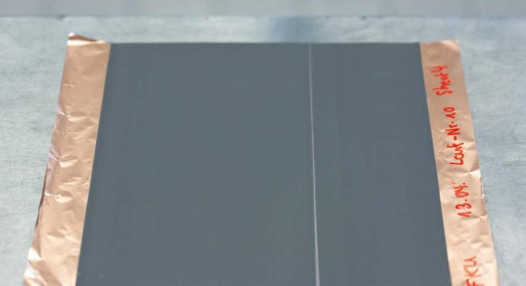
As áreas onde a pasta não foi aplicada levam a rejeitos e devem ser identificadas. O sensor de visão Dualis da ifm sinaliza esse erro e, assim, ajuda a minimizar a quantidade de rejeitos.
