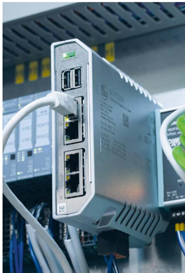
*O controlador IIoT transmite todos os dados dos sensores para o nível superior de TI, onde estão disponíveis continuamente para o cliente da EREMA tanto via laptop quanto por smartphone.*
