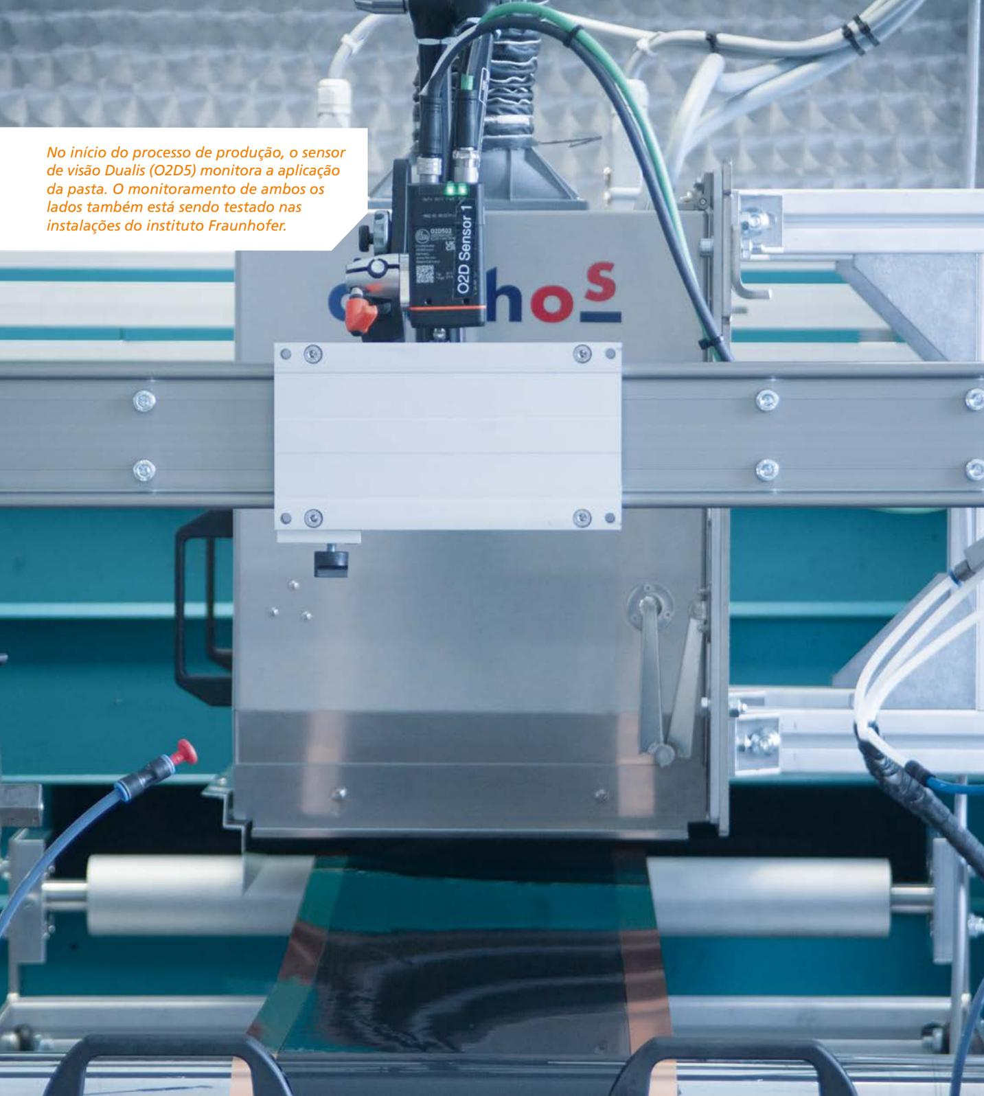
No início do processo de produção, o sensor de visão Dualis (O2D5) monitora a aplicação da pasta. O monitoramento de ambos os lados também está sendo testado nas instalações do instituto Fraunhofer.
