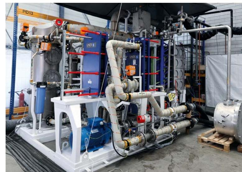
*O sistema de propulsão a hidrogênio K2 desenvolvido pela Koedood e Koimaan é testado da instalação.*
