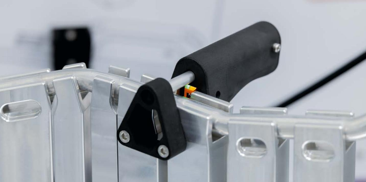
*Um dos vários sensores ópticos detecta se a linha está inserida no medidor. O bloqueio só é liberado quando todas as etapas da verificação de qualidade são concluídas com êxito.*
