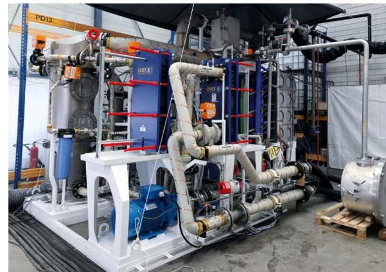
La propulsione a idrogeno K2, sviluppata da Koedood e Kooiman, viene testata prima dell'installazione.
