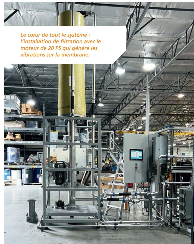
Le cœur de tout le système : l'installation de filtration avec le moteur de 20 PS qui génère les vibrations sur la membrane.
