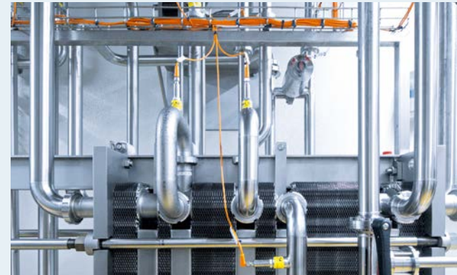
قلب المصنع: مبادل حراري لوجي للتحكم الدقيق في درجة حرارة الحليب الخام
