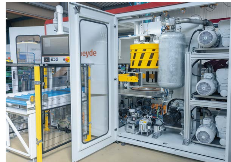
Sistema de teste de vazamento da empresa von der Heyde.
