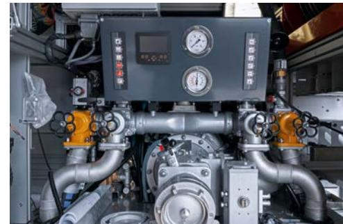
Für die Verarbeitung der Durchfluss-, Füllstand- und RFID-Daten aus dem Feld wurde ein programmierbares Grafikdisplay zur Steuerung von mobilen Arbeitsmaschinen des Typs CR1058 implementiert, welches die gesamten Informationen über das Ethernet/IP-Protokoll erfasst, sie auf dem Bildschirm im Fahrzeug anzeigen
