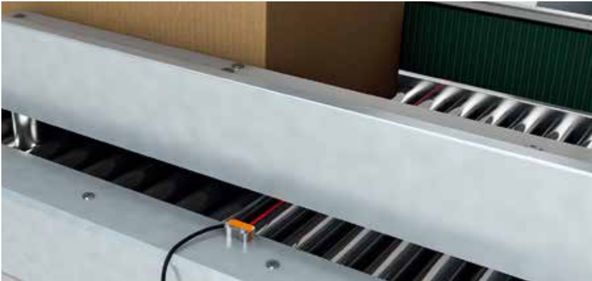
用于检测货物的小型光电传感器
