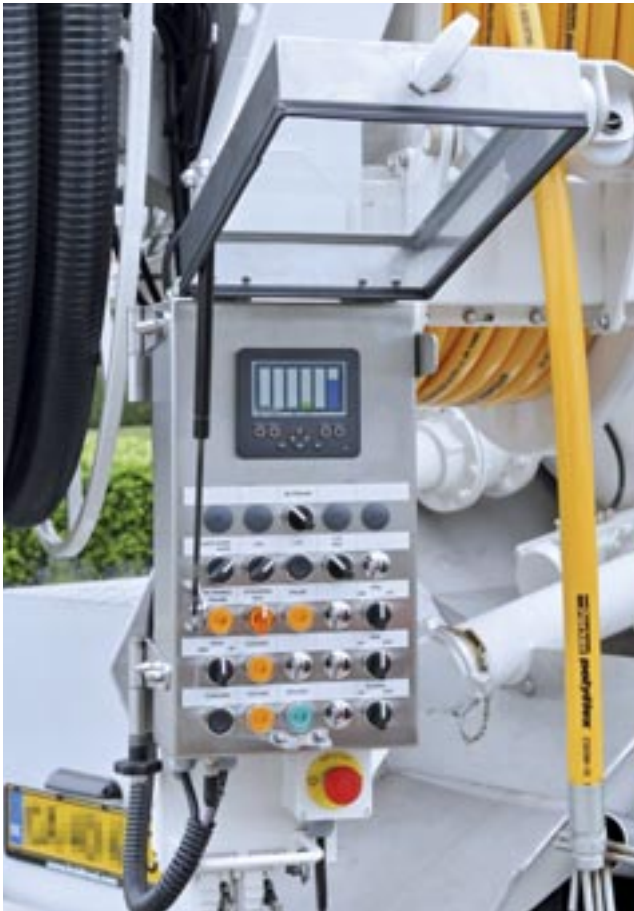
Das BasicDisplay CR0451 zeigt am Bedienpult die wichtigsten Parameter an.
