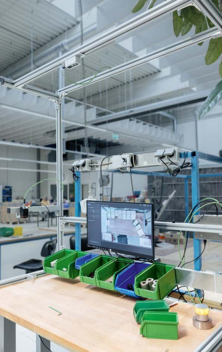
*ifm mate como solución completa: la cámara (sobre la estación de trabajo), el software y el PC pueden ampliarse sin problemas con una pantalla táctil, una baliza de señalización (abajo a la derecha en la imagen) y el sensor de visión O2D5 (en el margen izquierdo de la imagen, montado en el travesaño).*
