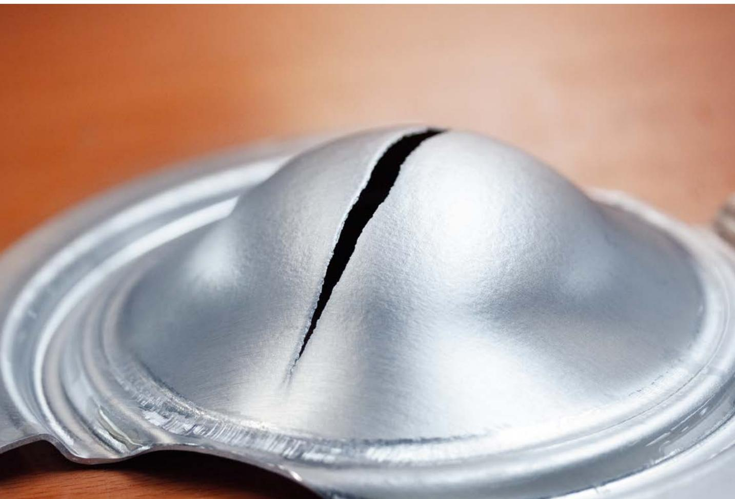
*Este objeto de prueba muestra la típica grieta obtenida durante el ensayo tipo Nakajima. La sobrecarga selectiva del material proporciona información sobre si es posible, por ejemplo, su transformación en una pieza de automoción.*
