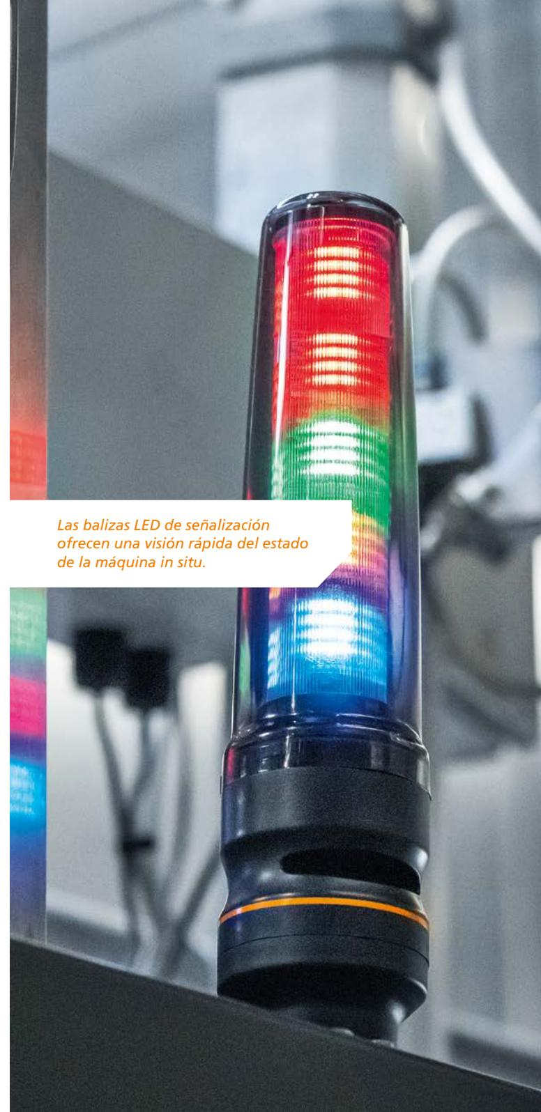
*Las balizas LED de señalización ofrecen una visión rápida del estado de la máquina in situ.*
