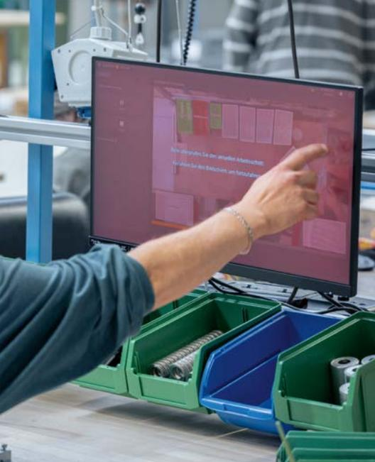
*Imagen izquierda: si el sensor de visión O2D5 comprueba correctamente el contorno, el trabajador recibe una respuesta positiva en forma de un marco verde rodeando la imagen comprobada.*
