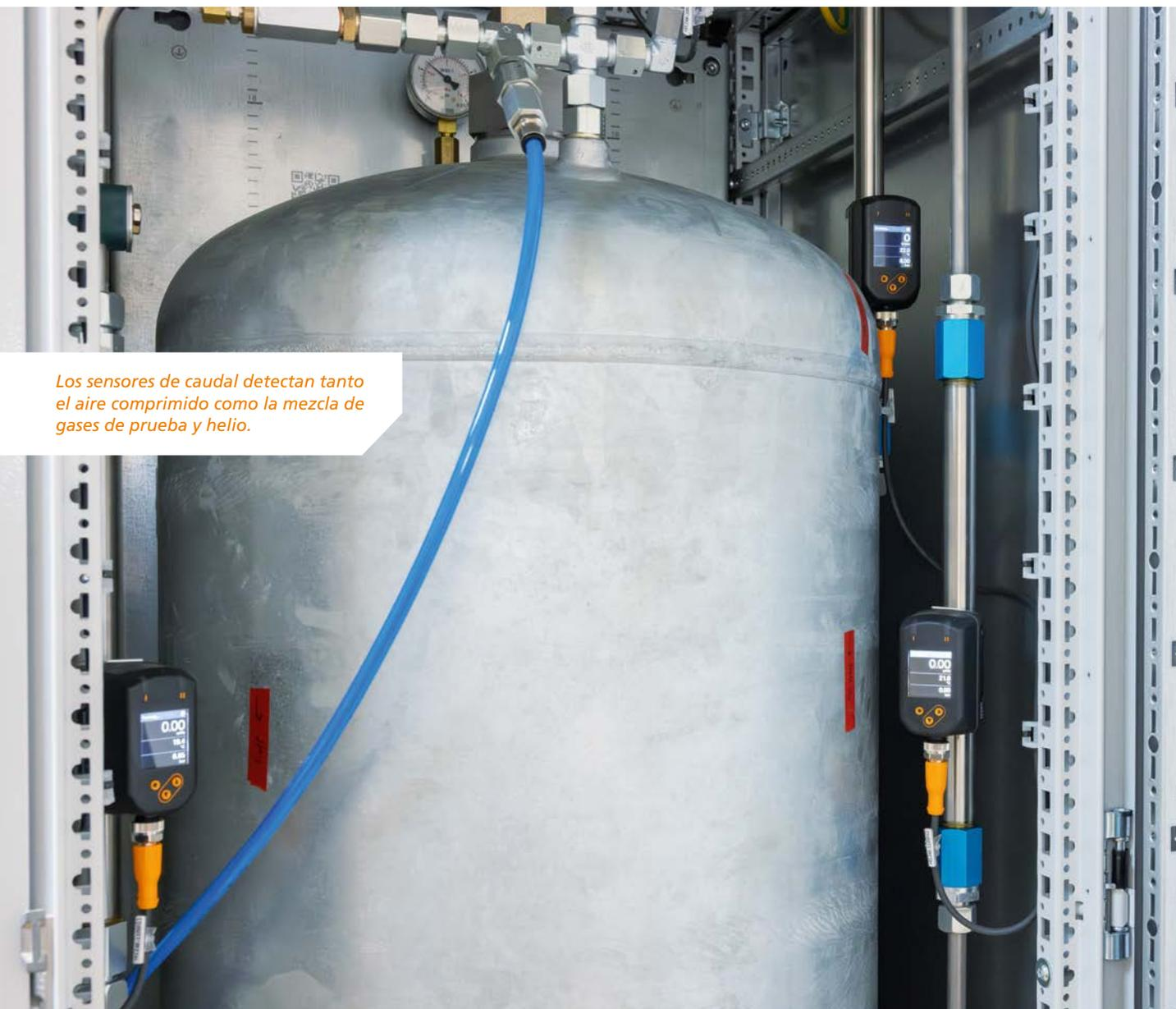
Los sensores de caudal detectan tanto el aire comprimido como la mezcla de gases de prueba y helio.
