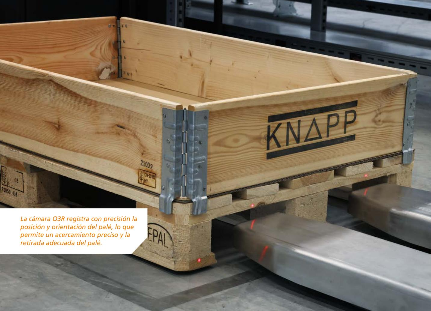
La cámara O3R registra con precisión la posición y orientación del palé, lo que permite un acercamiento preciso y la retirada adecuada del palé.
