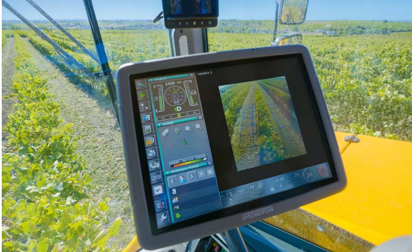
*Il conducente controlla solo la velocità di lavoro, mentre EasyPilot si occupa della guida.*
