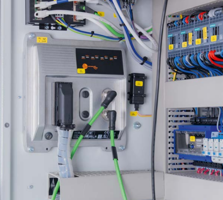
El controlador central para aplicaciones móviles CR710S incluye un PLC "normal" y un segundo PLC de seguridad independiente.
