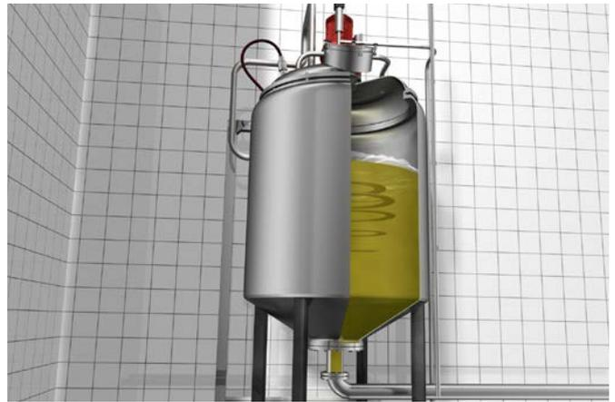
発酵タンクの圧力測定
