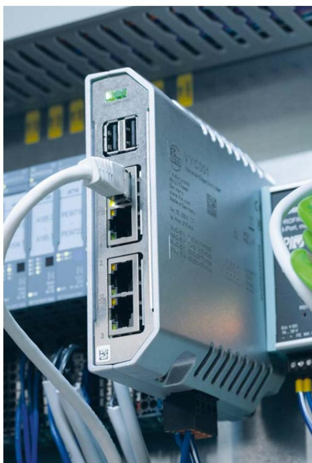
*Controller IIoT trasmette tutti i dati dei sensori al livello IT superiore, dove i clienti EREMA possono accedervi in qualsiasi momento con un computer portatile o uno smartphone.*
