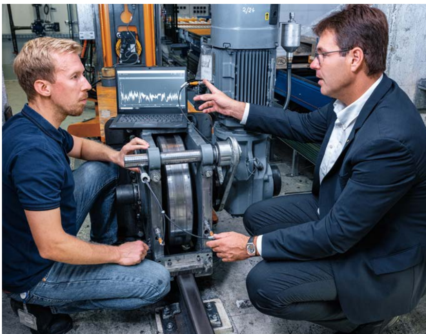
診斷軟體 moneo 可解釋震動資料，並在出現異常時發出警示，支援現場調整與校正。
