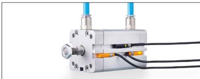
**Un sensore invece di due:** sui cilindri a corsa breve basta un sensore IO-Link per cilindri (scanalatura in alto) per rilevare entrambe le posizioni, anziché utilizzare due sensori convenzionali (scanalatura in basso) come avveniva in passato.
