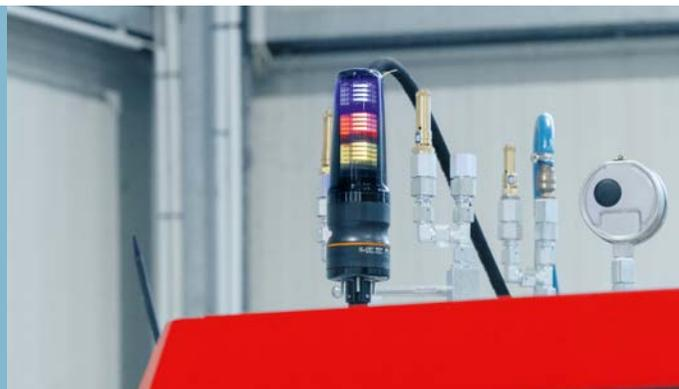
La lampe LED basée IO-Link est bien visible de loin et dispose d'un générateur de signal acoustique.
