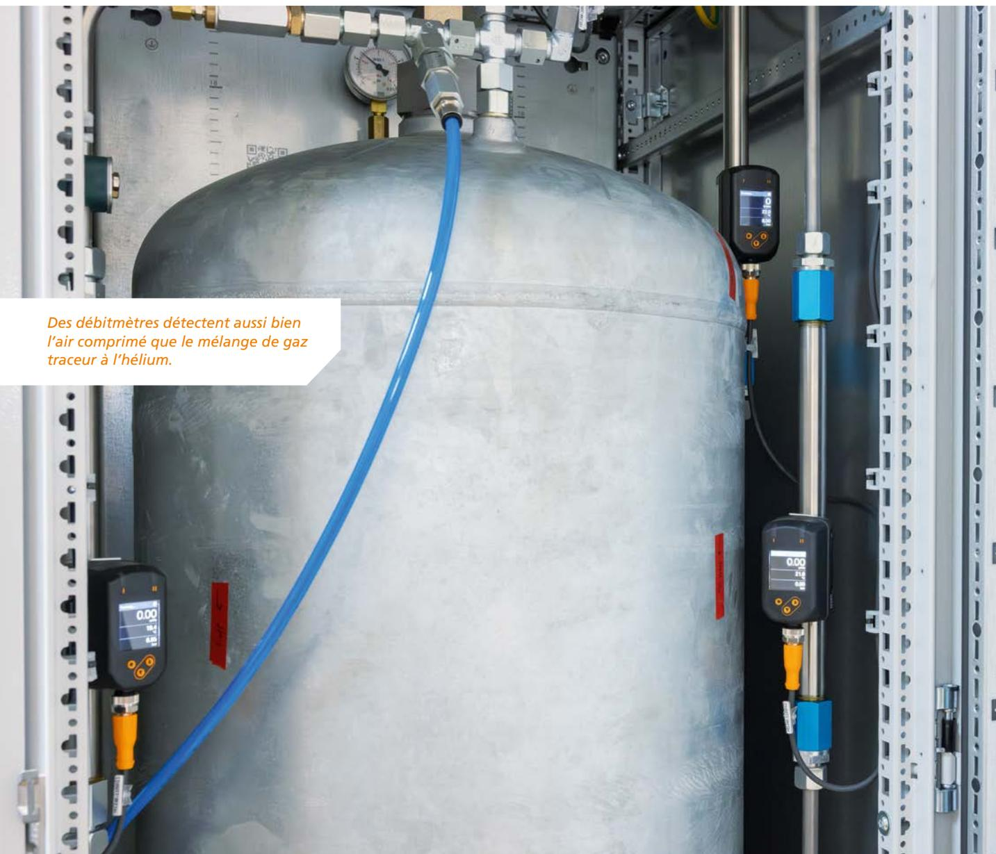
Des débitmètres détectent aussi bien l'air comprimé que le mélange de gaz traceur à l'hélium.
