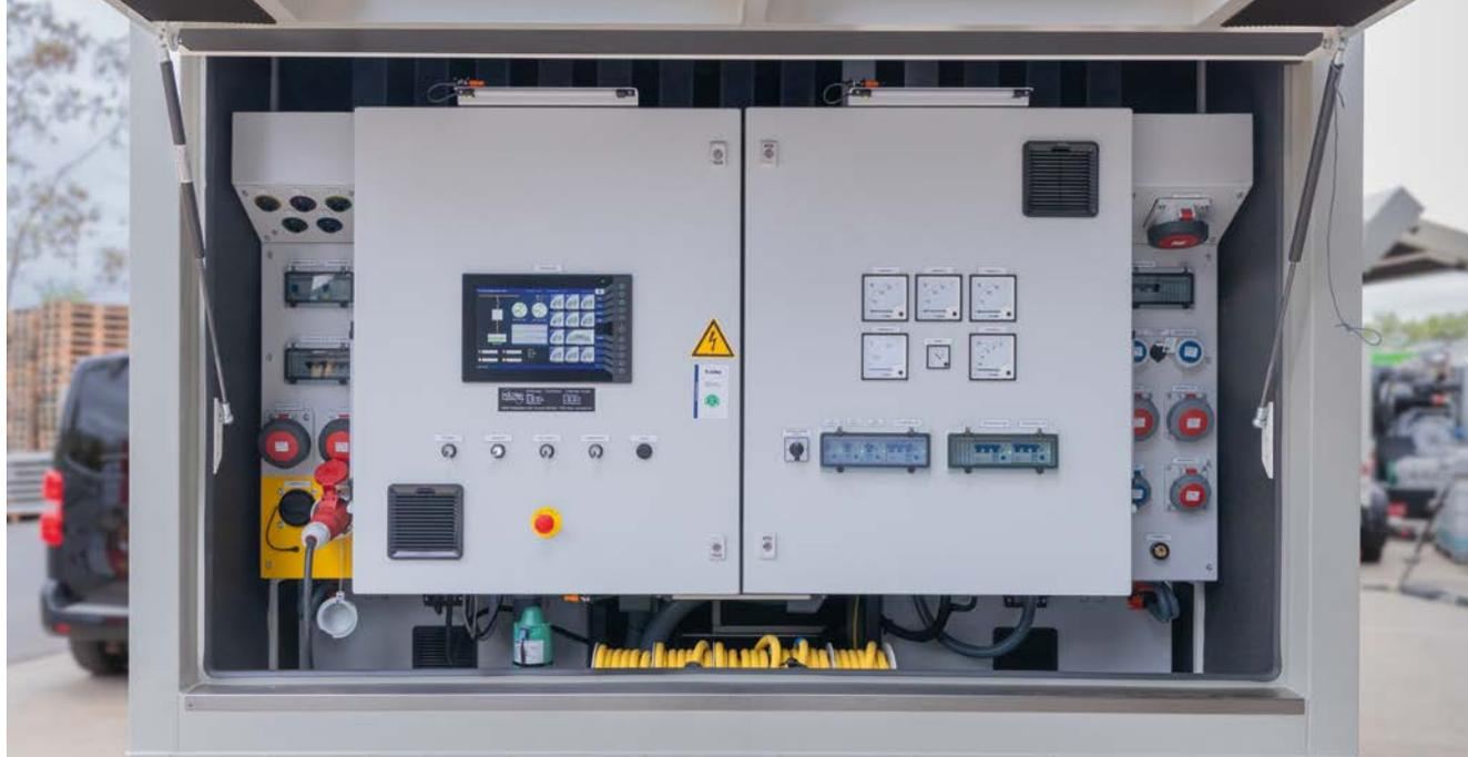
*A l'arrière du véhicule se trouvent le centre de commande ainsi que les différentes prises de courant.*
