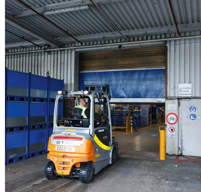
*Si la porte roulante, très fréquemment utilisée, reste ouverte trop longtemps par temps froid, cela engendre une augmentation des coûts de chauffage.*
