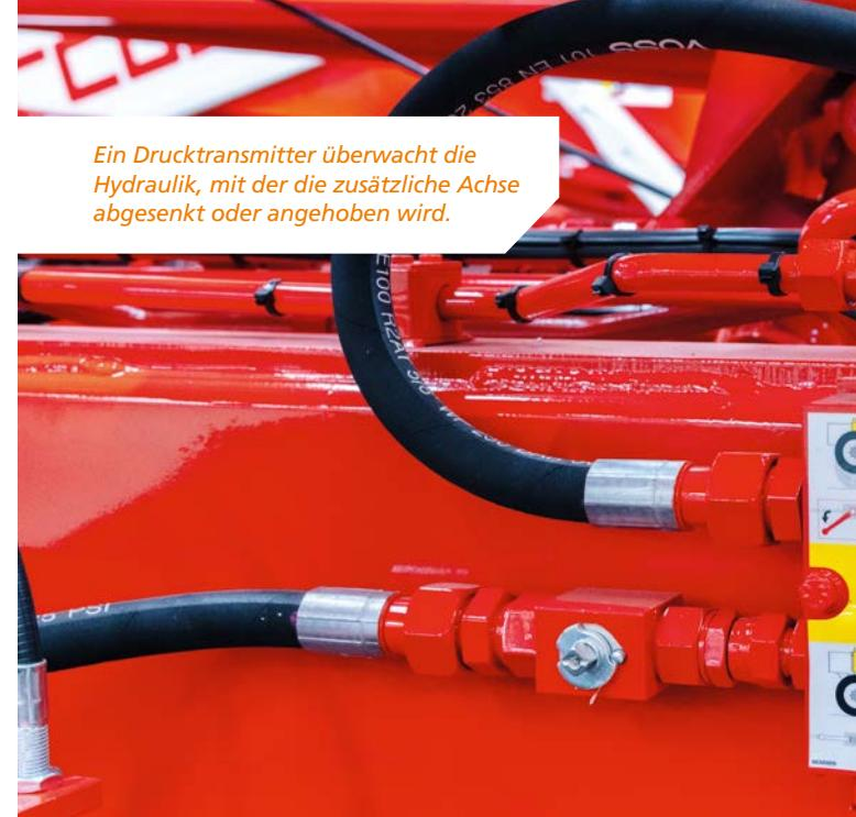
*Ein Drucktransmitter überwacht die Hydraulik, mit der die zusätzliche Achse abgesenkt oder angehoben wird.*
