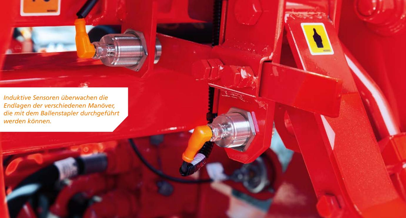
*Induktive Sensoren überwachen die Endlagen der verschiedenen Manöver, die mit dem Ballenstapler durchgeführt werden können.*
