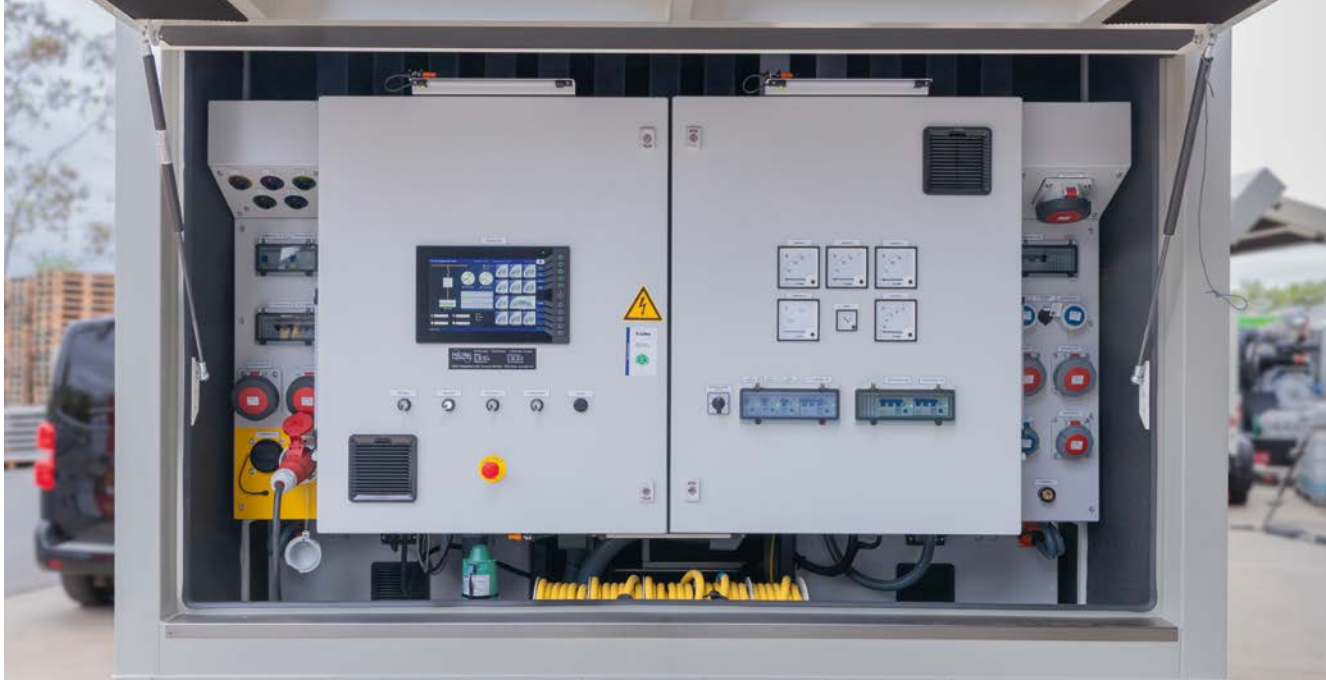
Sul retro del veicolo si trovano la centrale di comando e i vari collegamenti elettrici.
