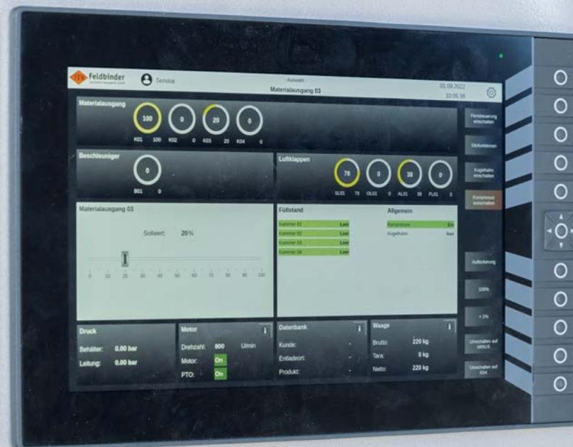
Das zum Einsatz kommende ecomatDisplay mit kapazitivem 12-Zoll-Touchscreen und frei belegbaren Tasten ist für den mobilen Einsatz in der Kabine sowie im Außenbereich konzipiert. Integriert ist eine leistungsstarke Steuerung, die mit CODESYS individuell programmiert werden kann. Mit dem ecomatPanel ergänzt die Firma Feldbinder das Display.
